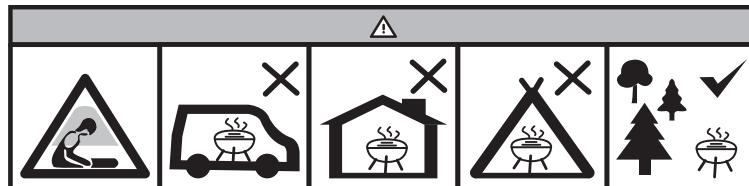
Vid grillning kan kolmonoxid eller andra giftiga gaser/ångor bildas p.g.a. att brännbart material används. Dessa är i regel luktlösa och kan vara dödliga. Av den anledningen får grillen användas **enbart** utomhus.
