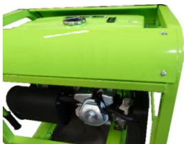
Retirar la cubierta lateral. de arranque.
