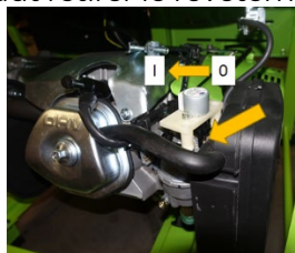
Papillon des gaz position «0» pour la procédure de démarrage. Position «I» en fonctionnement.
