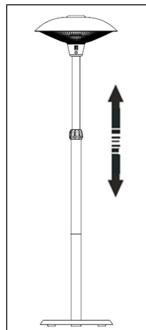
**Krok 9:** Dodanú skrutku zaskrutkujte do teleskopickej trubice tak, aby už nemohla sklúzať do hornej časti (aby sa nastaviteľná časť upevnila a zaistila).
