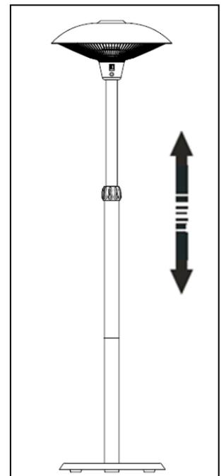
**Stap 9:** Schroef de meegeleverde schroef in de telescopische buis zodat deze niet meer in het bovenste deel kan schuiven (om het verstelbare deel vast te zetten en te borgen).
