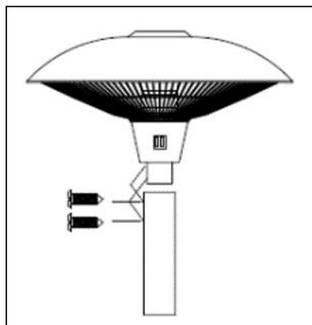
**Steg 7:** Kontrollera att teleskopröret är helt utdraget. Fäst teleskopröret i det maximalt utdragna läget genom att vrida åt justeringsringen. Dra försiktigt ut nätkabeln ur sockeln. Fäst nätkabeln under den nedtyngda sockeln med de 4 medföljande M4-muttrarna. Se till att nätkabeln inte är spänd i rören. Se till att nätkabeln är lång nog att apparaten kan ställas in på det högsta läget, men undvik överflödigt nätkabel i rören.
