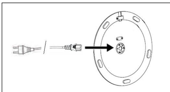
**Krok 5:** Připojte zástrčku k přípojce topného tělesa. Zajistěte toto připojení dodanou svorkou. Dbejte na to, aby šipka na svorce ukazovala směrem na horní stranu terasového ohřívače.
