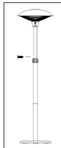
**Steg 10 (valfritt):** Borra 3 hål i underlaget för att fästa terrassvärmaren i underlaget. Borra de 3 hålen med jämna mellanrum runt basdelens kant och se till att alla bultar är ordentligt åtdragna med en nyckel.
