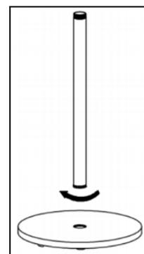
**Pasul 2:** Fixați tubul superior (telescopic) pe tubul inferior, prin înșurubare.
