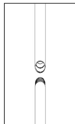
**Pasul 3:** Trageți tubul interior (telescopic) din tubul exterior și fixați-l, strângând piulița de fixare de culoare neagră.
