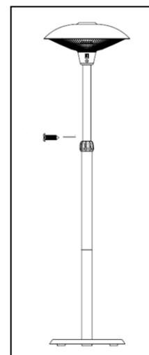
**Schritt 10 (eventuell):** Um der Terrassenheizstrahler am Boden zu befestigen, bohren Sie 3 Löcher in den Boden. Bohren Sie diese 3 Löcher gleichmäßig am Rand des Basisteils und achten Sie darauf, dass jeder Bolzen mit einem Schraubenschlüssel richtig festgedreht ist.
