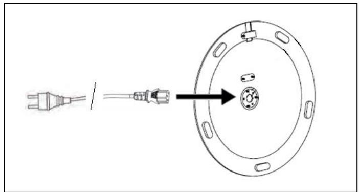
**Schritt 5:** Verbinden Sie den Kupplungsstecker mit dem Steckeranschluss des Heizpilzes. Sichern Sie diese Anschlussverbindung mit der mitgelieferten Klemme. Achten Sie darauf, dass der Pfeil auf der Klemme auf die Oberseite des Terrassenheizers zeigt.
