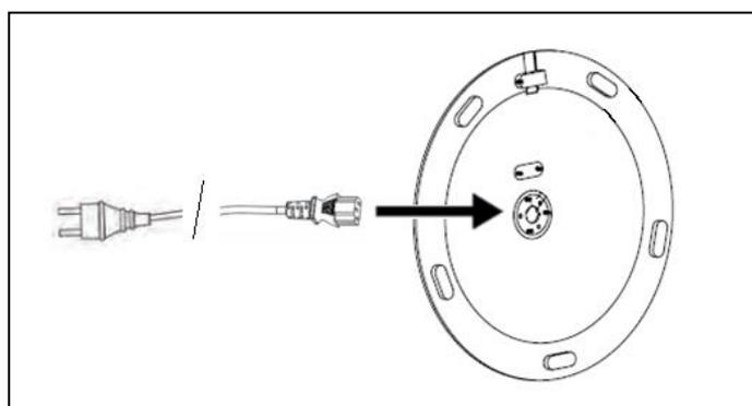
**Krok 5:** Pripojte zásuvku so zástrčkou na výhrevnú časť. Toto spojenie zaistite pomocou dodanej svorky. Uistite sa, že šípka svorky smeruje k hornej časti terasového ohrievača.
