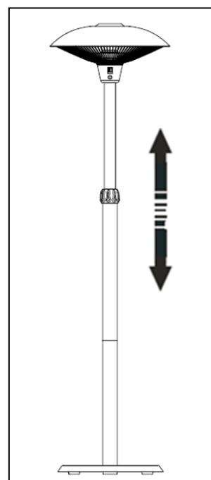
**Krok 9:** Zašroubujte dodaný šroub do teleskopické trubky, aby se tato již nemohla více zasunout do horní části (k upevnění a zajištění nastavitelné části).
