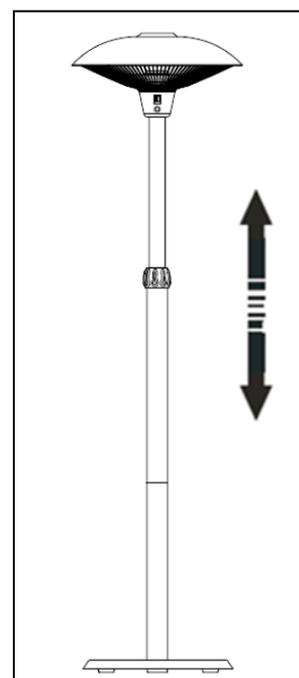
**Steg 9:** Skruva i den medföljande skruven i teleskopröret så att det inte längre kan glida in i den övre delen (för att sätta fast och säkra den justerbara delen).
