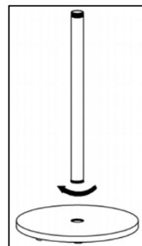
**Steg 2:** Skruva ihop det övre röret (teleskopröret) och det nedre röret.
