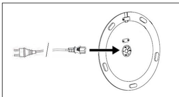
**Stap 5:** Verbind de contrastekker met de stekkeraansluiting van de verwarmingskap. Borg deze aansluiting met de bijgeleverde klem. Zorg ervoor dat de pijl van de klem naar de bovenkant van de terrasstraler wijst.
