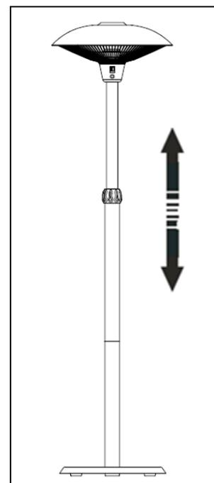
**Etape 9 :** Vissez la vis fournie dans le tube télescopique afin qu'elle ne puisse plus glisser dans la partie supérieure (pour fixer et sécuriser la partie réglable).
