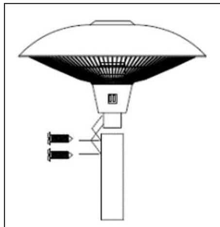
**Krok 7:** Skontrolujte, či je teleskopická trubica úplne vysunutá. Zaistite teleskopickú trubicu v tejto maximálnej polohe utiahnutím čiernej spojovacej matice. Opatrne vytiahnite napájací kábel zo základne. Zaistite napájací kábel pod zaťaženou základňou pomocou 4 dodávaných matíc M4. Nenapínajte napájací kábel v trubiciach. Ponechajte dostatočný priestor pre napájací kábel, aby bol spotrebič v najvyššej polohe, ale vyvarujte sa nadmernému napájaciemu káblu v trubiciach.
