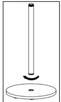
**Schritt 2:** Schrauben Sie die obere (Teleskop-)Stange an die untere Stange.
