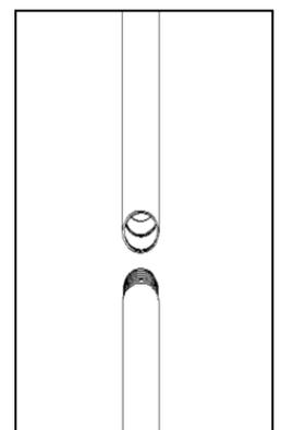
**Krok 3:** Vytáhněte vnitřní (teleskopickou) trubku z vnější trubky a zajistěte ji utažením černé převlečné matice.
