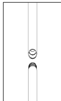
**Krok 3:** Vytiahnite vnútornú (teleskopickú) trubicu z vonkajšej trubice a zaistite ju utiahnutím čiernej spojovacej matice.
