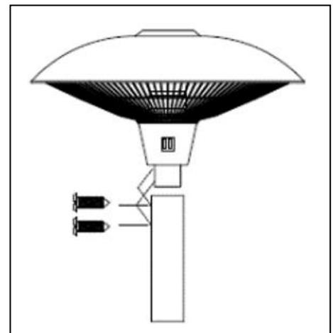
**Schritt 7:** Prüfen Sie, ob die Teleskopstange vollständig ausgefahren ist. Sichern Sie die Teleskopstange in dieser maximalen Position, indem Sie die schwarze Überwurfmutter andrehen.
