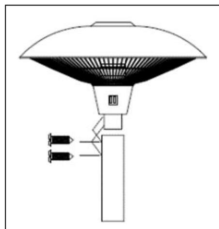
**Pasul 7:** Verificați dacă tubul telescopic este extins la maxim. Fixați tubul telescopic în această poziție de maximă extindere, strângând piulița de fixare de culoare neagră.
