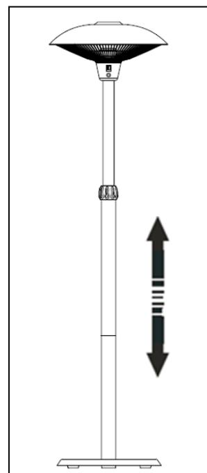
**Schritt 9:** Schrauben Sie die mitgelieferte Schraube in die Teleskopstange, um ein Verschieben in das obere Teil zu verhindern (zur Sicherung und Arretierung des verstellbaren Teils).
