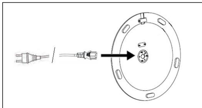
**Steg 5:** Anslut kontakten till uttaget på uppvärmningshuvudet. Säkra anslutningen med den medföljande klämman. Se till att pilen på klämman pekar mot terrassvärmarens ovansida.
