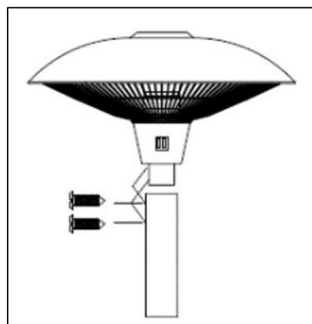
**Krok 7:** Zkontrolujte, zda je teleskopická trubka maximálně vysunutá. Zajistěte teleskopickou trubku v této maximální pozici utažením černé převlečné matice.
