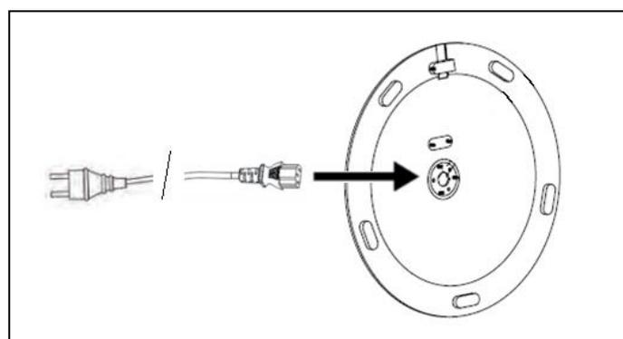
**Pasul 5:** Conectați fișa-mamă la conectorul cu fișe al reflectorului de încălzire. Fixați acest conector cu ajutorul clemei incluse în pachet. Asigurați-vă că săgeata de pe clemă este orientată spre partea superioară a încălzitorului de terasă.
