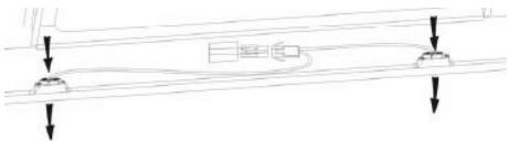
Odpojte bod spojenia žiarovky a vyberte žiarovku a vodiče z odsávača.
