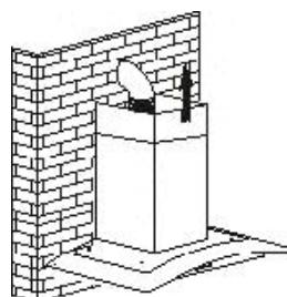
iv. Vysunutím krytu nastavte výšku odsávača. Po dosiahnutí požadovanej výšky pripojte upevňovací otvor skrutkami podľa obrázka.
