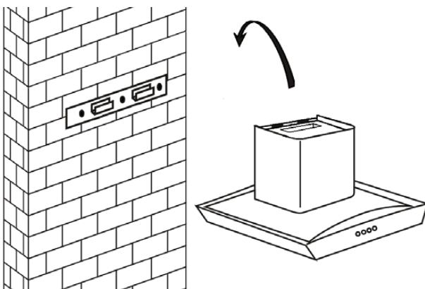
5. Pripevnite jednocestný ventil k výstupu vzduchu odsávača. Potom pripevnite odťahové potrubie k jednocestnému ventilu podľa obrázka.
