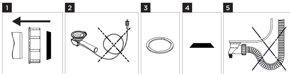
Opakowanie zawiera dwa rodzaje pieczęci. Uszczelka — 1 mm, montaż w zlewie oraz uszczelnienia B — 2 mm, montaż pod zlewozmywakiem.
