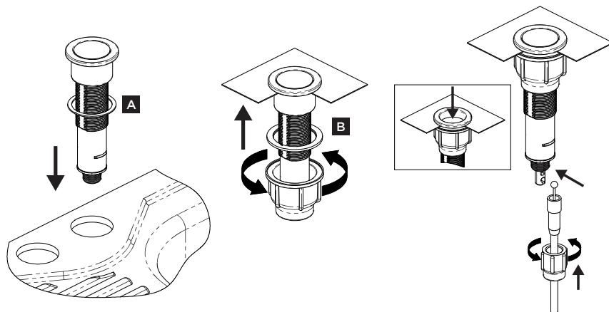
Za pomocą śruby ustawi kratkę spustową ze stali nierdzewnej w optymalnym położeniu.
