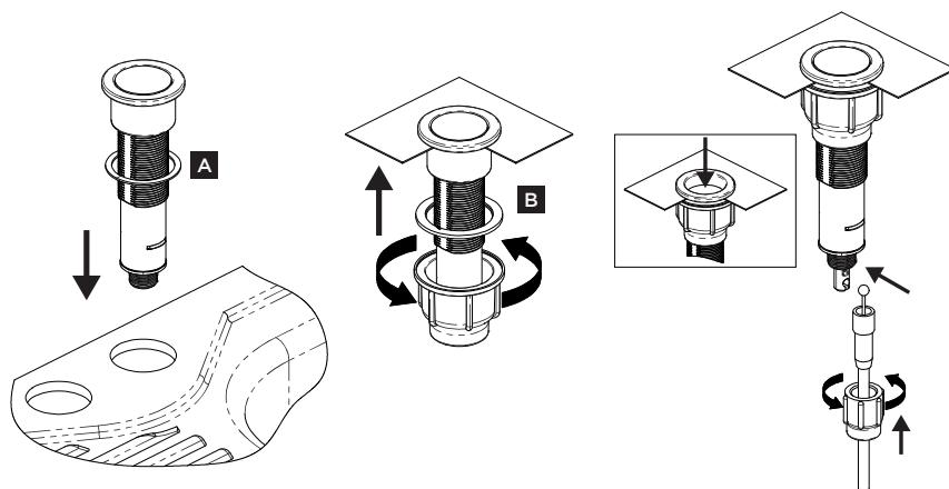
Nastavte nerezovú mriežku drezovej výpusti pomocou skrutky do optimálnej polohy.
