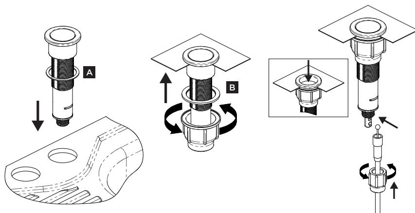
Nastavte nerezovou mřížku dřezové výpusti pomocí šroubu do optimální polohy.
