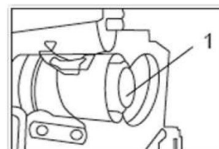
Čišćenje filtera vazduha
