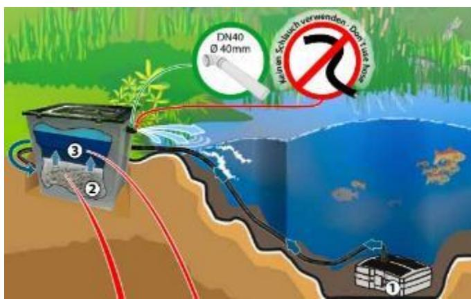
**Filtráciu** umiestnite k jazierku s výtokom vody nasmerovaným späť do jazierka, voda môže tieť z filtrácie priamo do jazierka, ale môžete filter umiestniť aj ďalej. Je potom potrebné na výtoku vody pomocou bežných inštalatérskych rúrok urobiť predĺženie pomocou kolena a rúrky DN 40 Ø 40 mm. Nepoužívajte hadicu došlo by k zúženiu, filter by potom mohol pretekať. Dbajte na to, aby bola filtrácia umiestnená vodorovne.
