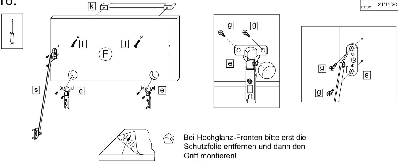
**T10** Bei Hochglanz-Fronten bitte erst die Schutzfolie entfernen und dann den Griff montieren!
