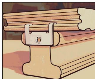
S terasovými doskami sa štandardne predávajú nerezové klipy s nerezovými vrutmi alebo plastové klipy s vrutmi. Klipy umožňujú tzv. skryté kotvenie terasových dosiek. Prvú terasovú dosku polož kolmo na pripravený nosič, prichyt ho k hrane nosiča pomocou Start klipu a priepevni nerezovým vrutom. Dieru pre vrut si predvŕtaj.
