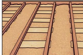
Pred kladením terasových dosiek nainštaluj nosiče, ktoré tvoria podpornú konštrukciu pre terasové dosky a súčasne zaistujú cirkuláciu vzduchu pod terasovými doskami. Nosič 50x50 mm alebo 50x30 mm nainštaluj v max. krajnej vzdialosti 250 mm (t. j. od hrany po hrane nosiča).
