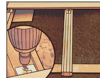
Než začneš s inštaláciou terasových dosiek, odporúčame si vopred pripraviť plán kladenia. Pred kladením odporúčame skontrolovať dĺžku dosiek a prípadne zarovaňa ich hrany. Dosky k nosičom upevňuj dodávanými klipmi a vrutmi.
