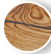
čelné a plošné praskliny
