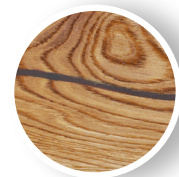
čelné a plošné praskliny
