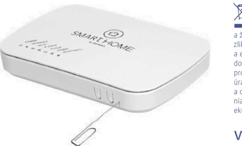
Gateway pred postúpením tretej osobe vynulujte, aby sa odstránil údaje. Na vynulovanie zariadenia zavedte, prosím, ceruzku do otvoru Reset na prednej strane Gateway a podržte za tým ležiaci gombík stlačený na 10 sekúnd. Pri vynulovaní Gateway treba zabezpečiť neprerušiteľný napájací zdroj.
