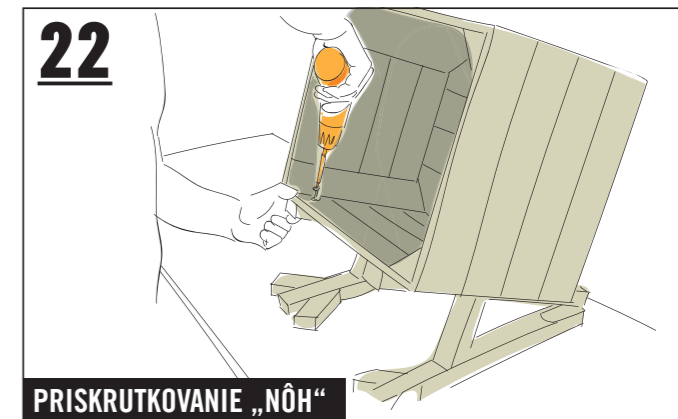
22 PRISKRUTKOVANIE „NÔH“ „Nohy“ priskrutkuj štyrmi skrutkami (4,5 x 30 mm) k debne.
