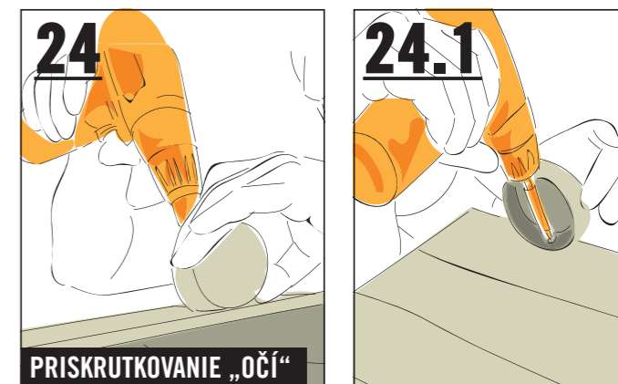
24 PRISKRUTKOVANIE „OČÍ“ Obidve „oči“ priskrutkuj jednou skrutkou (4,5 x 30 mm) k hornej strane debny (kvôli orientácii pozri krok 24.1). Nalep zreničky (filcové klzáky).
